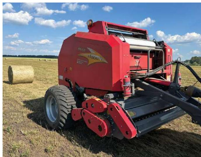
Конструкционные особенности FasCar позволяют работать на высокой скорости – до 35 км/ч и формировать при этом до двух тюков в минуту. Кроме того, агрегат ловко собирает как сухую массу, так и только что скошенную. Новые подходы, использованные в создании сельхозмашины, позволили увеличить объем подачи травяной массы, снизить вероятность засорения узлов агрегата. Еще одно преимуще-
